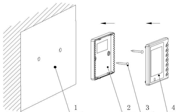
Рис. 45 Схема установки
