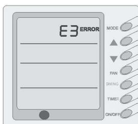
При возникновении неполадок в работе блока на экране мигает "ERROR" и выдается код ошибки. При одновременном возникновении нескольких неполадок коды ошибок отображаются по очереди. Первая цифра кода определяет системный номер. Если система одна, номером будет 1. Следующие 2 цифры определяют код ошибки. Например, код слева обозначает защиту низкого давления в компрессоре.
