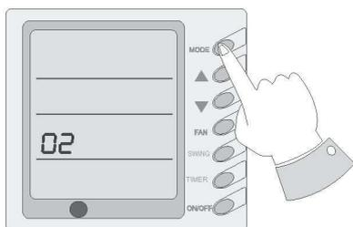
Нажмите и удерживайте кнопку "MODE" в течении 10 секунд при выключенном блоке для сохранения настроек блока. Если в зоне установленной температуры отображается 01, будет сохранено состояние блока при эксплуатации; 02 означает отсутствие сохранения. Нажмите кнопку "ON/OFF" для подтверждения ввода и выхода из режима настройки.
