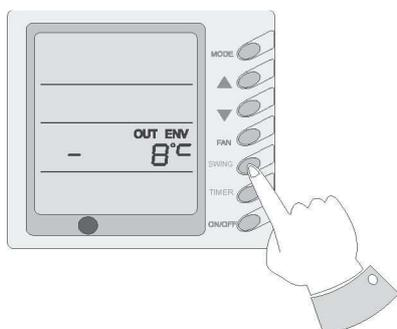
В обычных условиях работы в зоне "OUT ENV" должна отображаться только внутренняя температура. Нажмите и удерживайте кнопку "SLEEP" в течении 5 секунд при выключенном блоке и на экране появится "OUT ENV". После отображения наружной температуры в течении 10 секунд система вернется к отображению внутренней температуры. Примечание: Если кондиционер не оснащен датчиком наружной температуры, данная функция будет недоступна.
