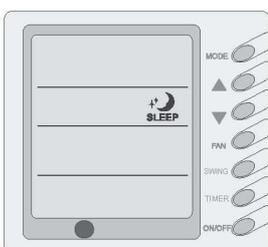
В режиме охлаждения или осушения, после получения инструкции сна SLEEP на 1 час, предыдущая заданная температура  $T_{set}$  повышается на 1 °C, затем еще на 1 °C через 2 часа, то есть температура повысится на 2°C в течении 2 часов. Затем кондиционер работает с новой температурой.
